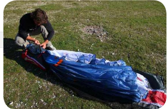
**Etape 8.** Mettez en place le coussin de pliage et pliez le bord d'attaque autour de ce dernier. Faites trois plis.
